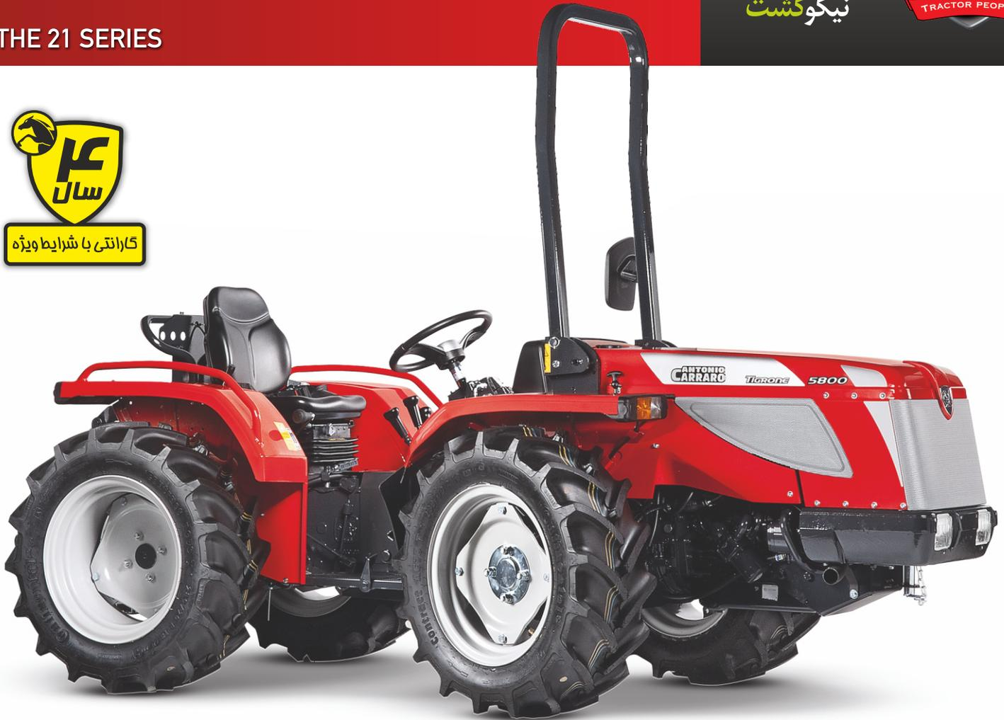
تراکتور محور شکن باغی **TIGRONE 5800** یک محصول جدید از تراکتورهای بی نظیر سری ۲۱ شرکت **CARRARO** با دو دیفرانسیل و چرخهای هم اندازه برای کار در زمین های هموار و همچنین ناهموار تپه ای و کوهستانی طراحی و ساخته شده است .
